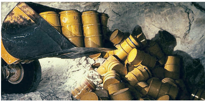
Ein Radlader kippt Fässer mit radioaktivem Müll in eine Kammer.
